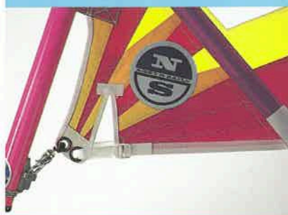
Twist Control Wave offen = weniger Achterfleksspannung, mehr Twist
