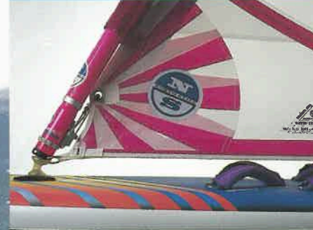
TC-Twist Control geschlossen = mehr Achterlieksspannung, weniger Twist
