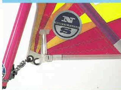
Twist Control Wave geschlossen = mehr Achterfleksspannung, weniger Twist
