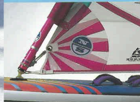
TC-Twist Control offen = weniger Achterlieksspannung, mehr Twist
